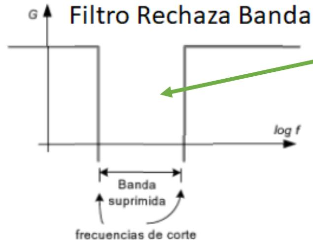
Las señales en esta banda (entre las frecuencias de corte) “se rechazan”.
