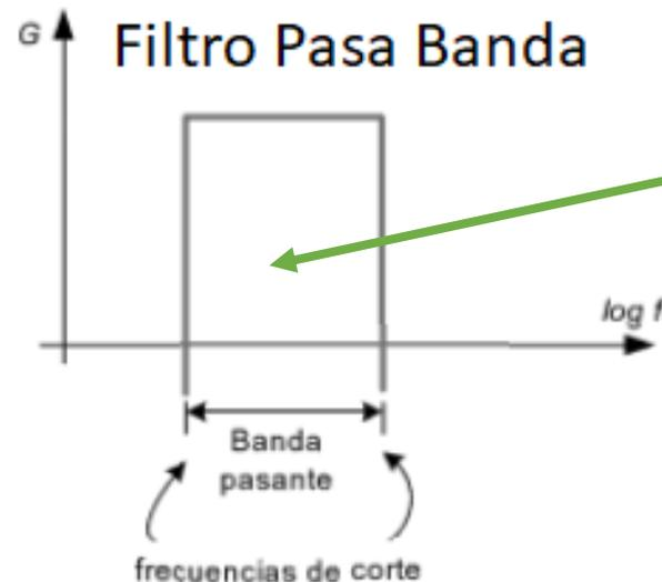
Solo las señales en esta banda (entre las frecuencias de corte) “pasan”.
