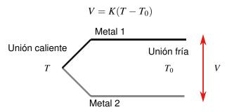
Unión caliente : punto de medición Unión fría: punto de referencia
